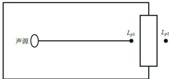
图 5.2-16 室内声源等效为室外声源图例
